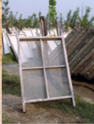
Wenn die Pulpe gleichmäßig auf dem Sieb liegt, wird es aus dem Bassin gehoben, das Wasser fließt zurück ins Bassin. Der Rahmen wird aufgestellt und der Bogen trocknet in der Sonne.
